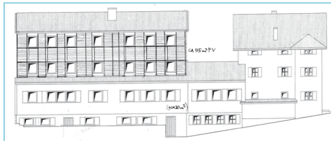
Variante 3: PV-Module statt Holzschindeln auf der Wand
