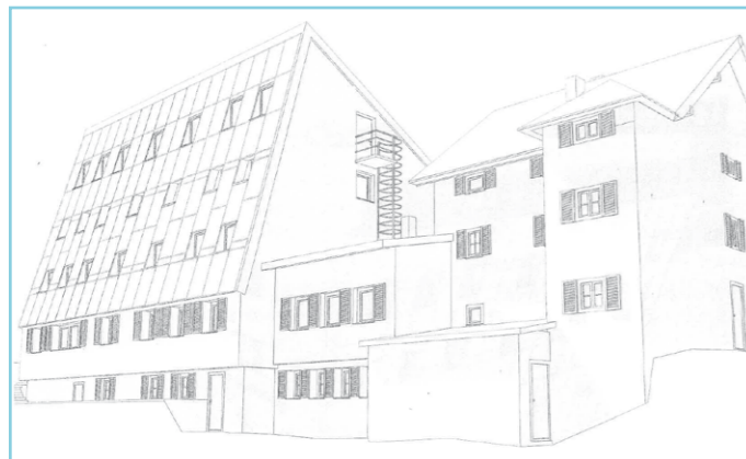
Variante 5: 75°-Dach mit In-Dach-Solarziegeln
